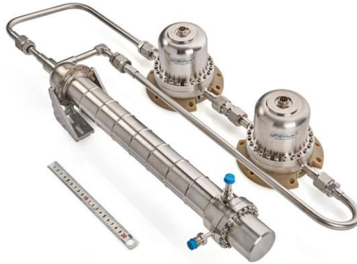
Slika 5.3. Grafički prikaz Braytonovog cryocoolera (Turbo Brayton).
