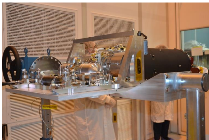
Slika 7.4. MIRI cryocooler iz JWST-a (MIRI).
