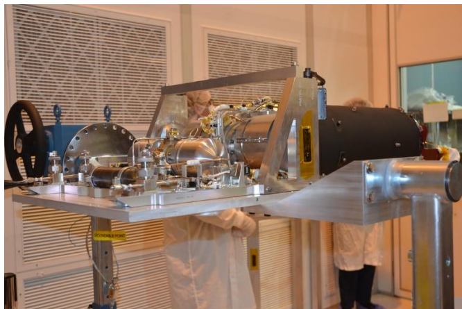
Slika 7.4. MIRI cryocooler iz JWST-a (MIRI).
