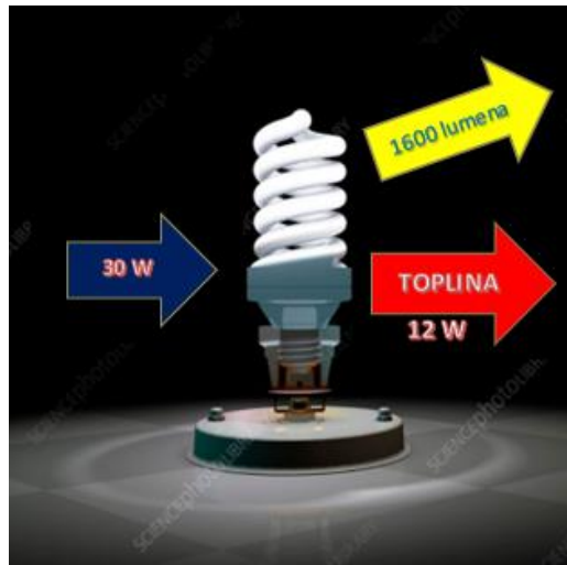
Slika 3.13. Energetska učinkovitost CFL žarulje snage 30 W [26]
