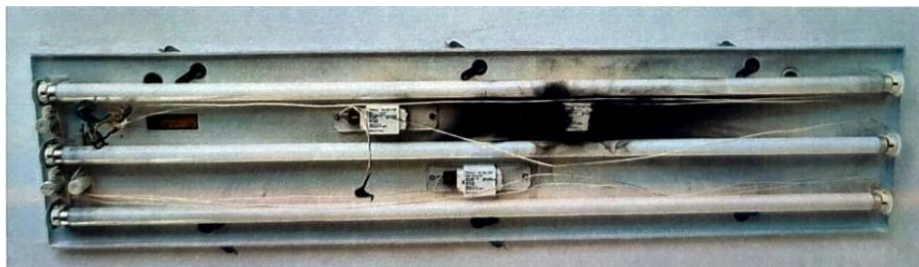
Slika 5.5. Razmjeri štete uslijed kratkog spoja jedne od prigušnica
