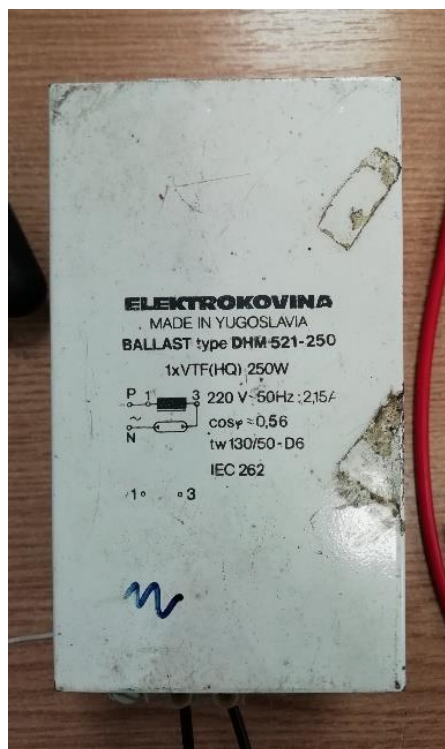
Sl. 3.4. Zavojnica korištena u pokusima
