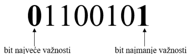
Slika 3.2. Binarni zapis broja s označenim bitovima
