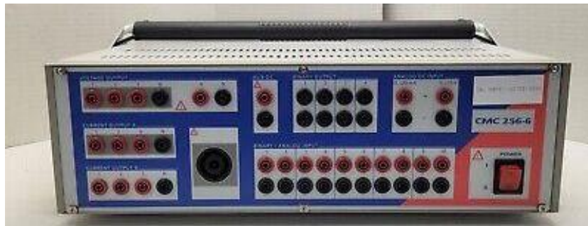
Slika 4.2. Uređaj za testiranje i kalibraciju Omicron CMC 256-6
