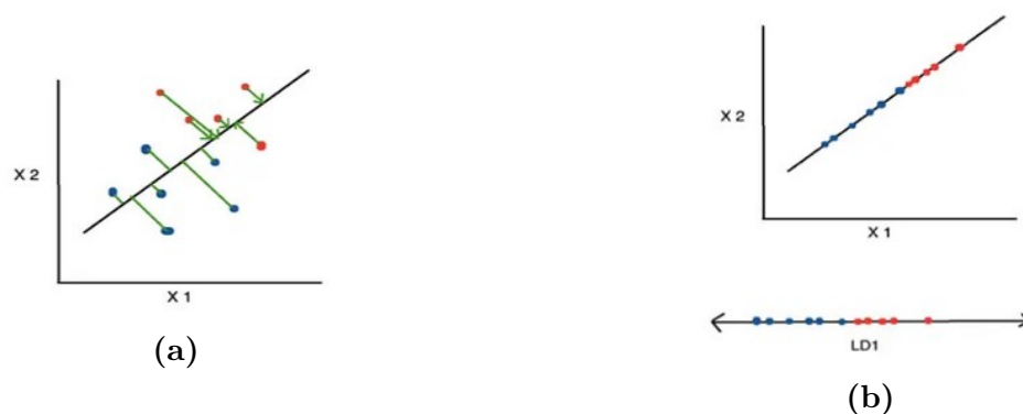
Slika 3.11: Novo generirani pravac pomoću algoritma LDA (a) i prikaz novog rasporeda u 1D ravnini (b) [26]
