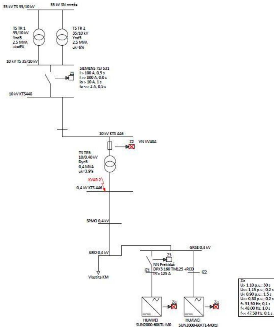
Sl. 5.6. Shematski prikaz simulacije za kvar 2
