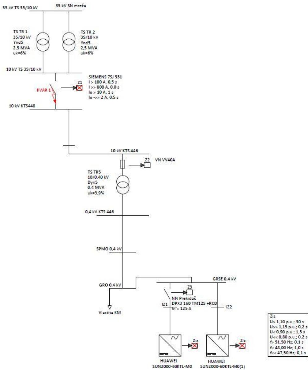
Sl. 5.4. Shematski prikaz simulacije za kvar 1
