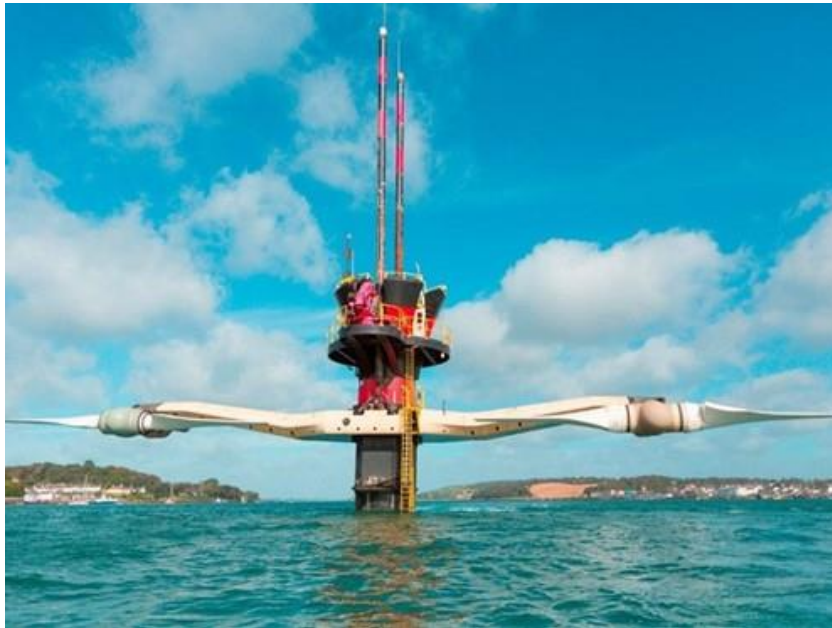
Slika 3.11. SeaGen turbina, podignuta iznad razine mora zbog održavanja [25]
