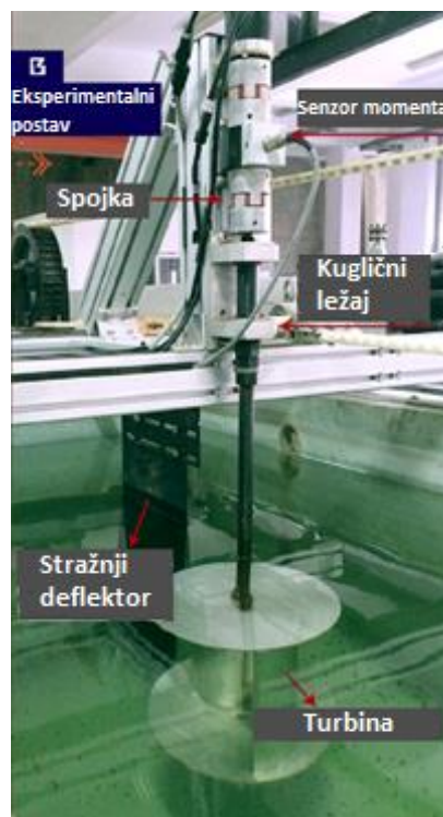
Slika 3.25. Eksperimentalni postav Savoniusove turbine sa ravnim deflektorom [35]
