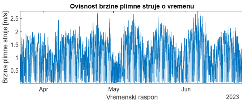
Slika 4.4. Graf ovisnosti brzine plimne struje o vremenu
