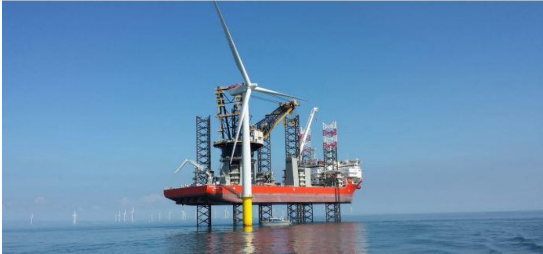
Slika 2.11 Brodica "Pacific Ospray" za instalaciju vjetroelektrana na pučini [8]
