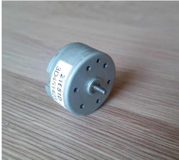
Slika 5.12. Motor male snage oznaka 21651D
