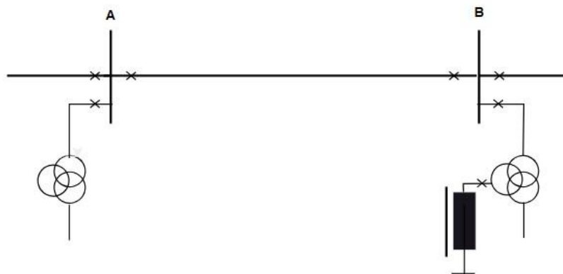
Slika 4.5. Paralelna prigušnica spojena na tercijar transformatora [11]
