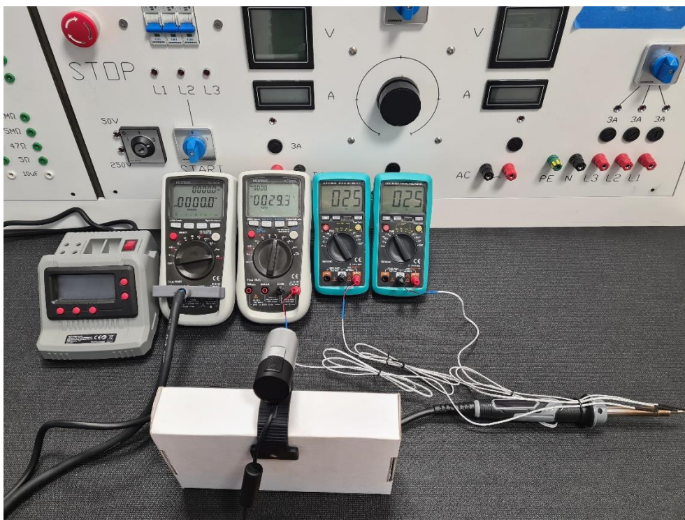
Slika 6.6. prikaz kompletnog spoja potrebnog za obavljanje mjerenja na lemnjnoj stanici Conrad Electronic LSL-450
