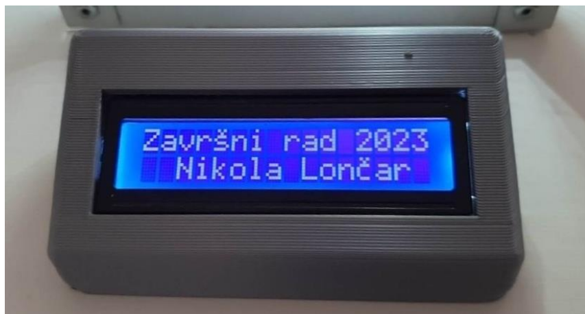
Sl. 3.14. Prikaz teksta ispisanog na 16x2 zaslonu
