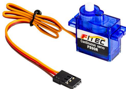
Sl. 3.12. 360 stupanjski servo motor [12]
