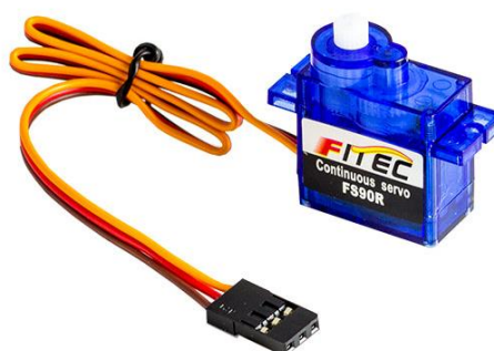
Sl. 3.12. 360 stupanjski servo motor [12]
