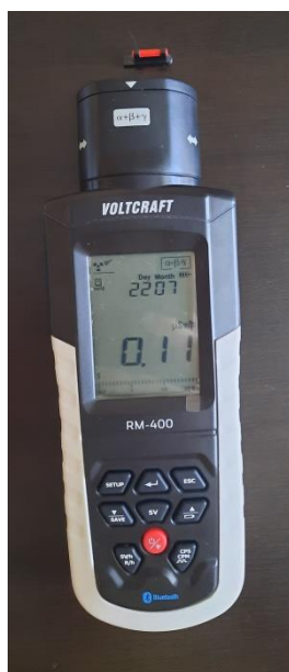
Slika 5.17. Izmjerena vrijednost zračenja mušice nišana oružja
