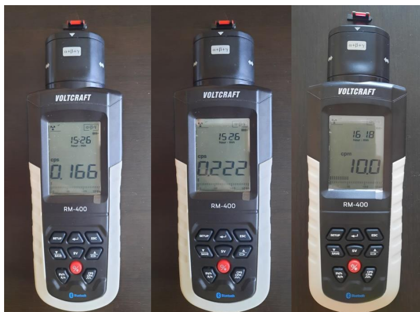
Slika 5.18. Izmjerena vrijednost cps (lijevo i sredina) i cpm (desno) za mušicu nišana oružja
