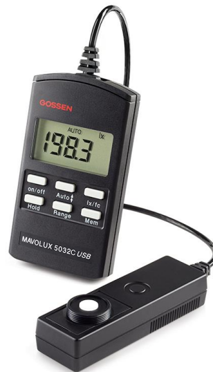
Sl. 4.3. Svjetlomjer Gossen Mavolux 5032C USB [15]
