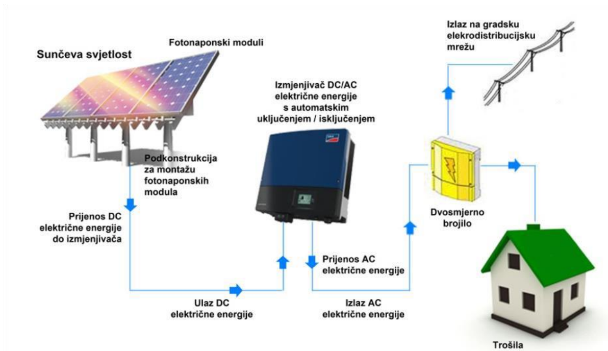
Slika 2.3. Pojednostavljeni prikaz mrežnog fotonaponskog sustava [5]
