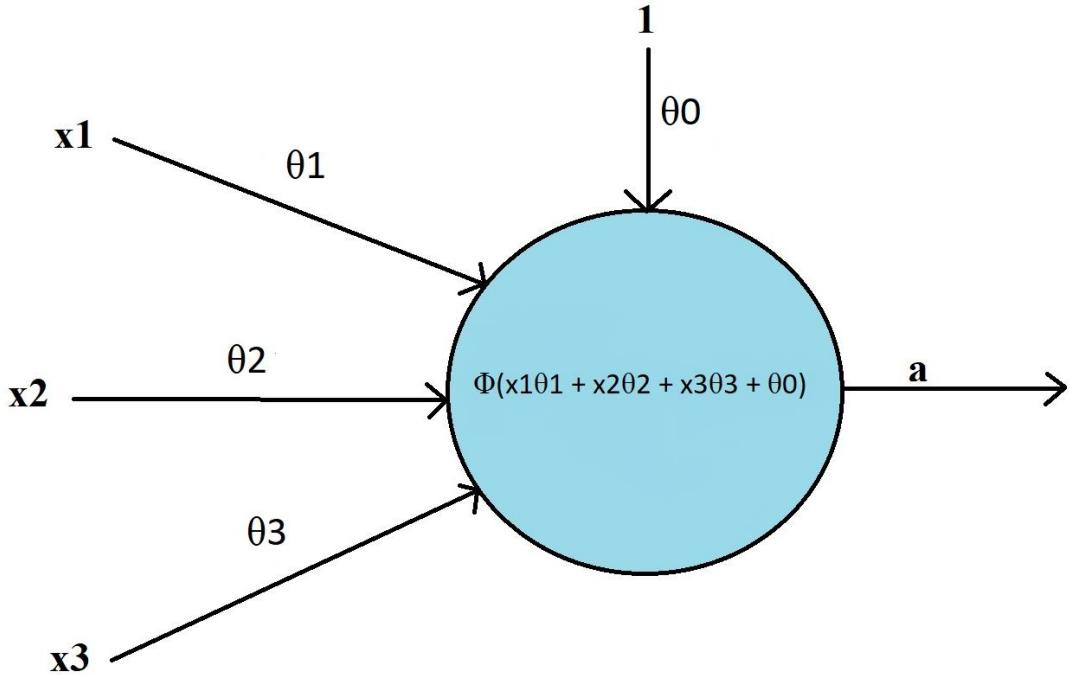
**Slika 3.3** Ilustracija jedinice s aktivacijskom funkcijom  $\Phi$ .
