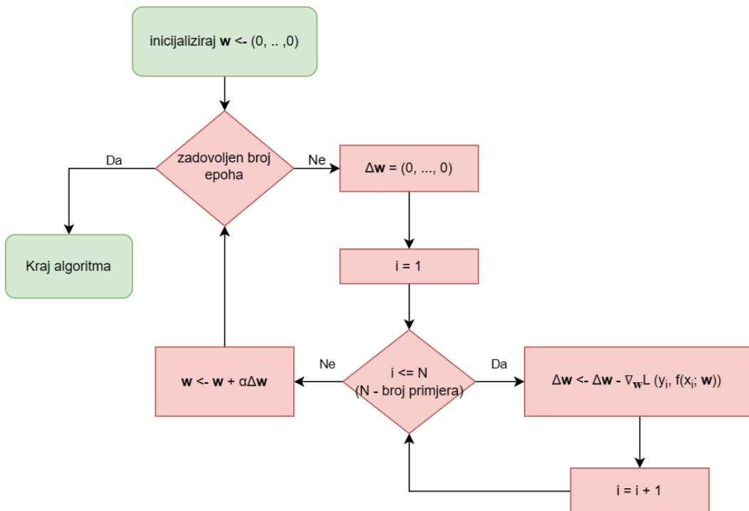
Slika 3.4 Dijagram toka grupnog gradijentnog spusta.
