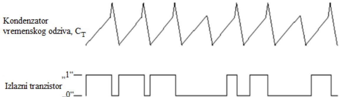
Slika 4.5. Grafički prikaz napona na kondenzatoru  $C_T$  i upravljački napon tranzistora  $Q2$  [9]
