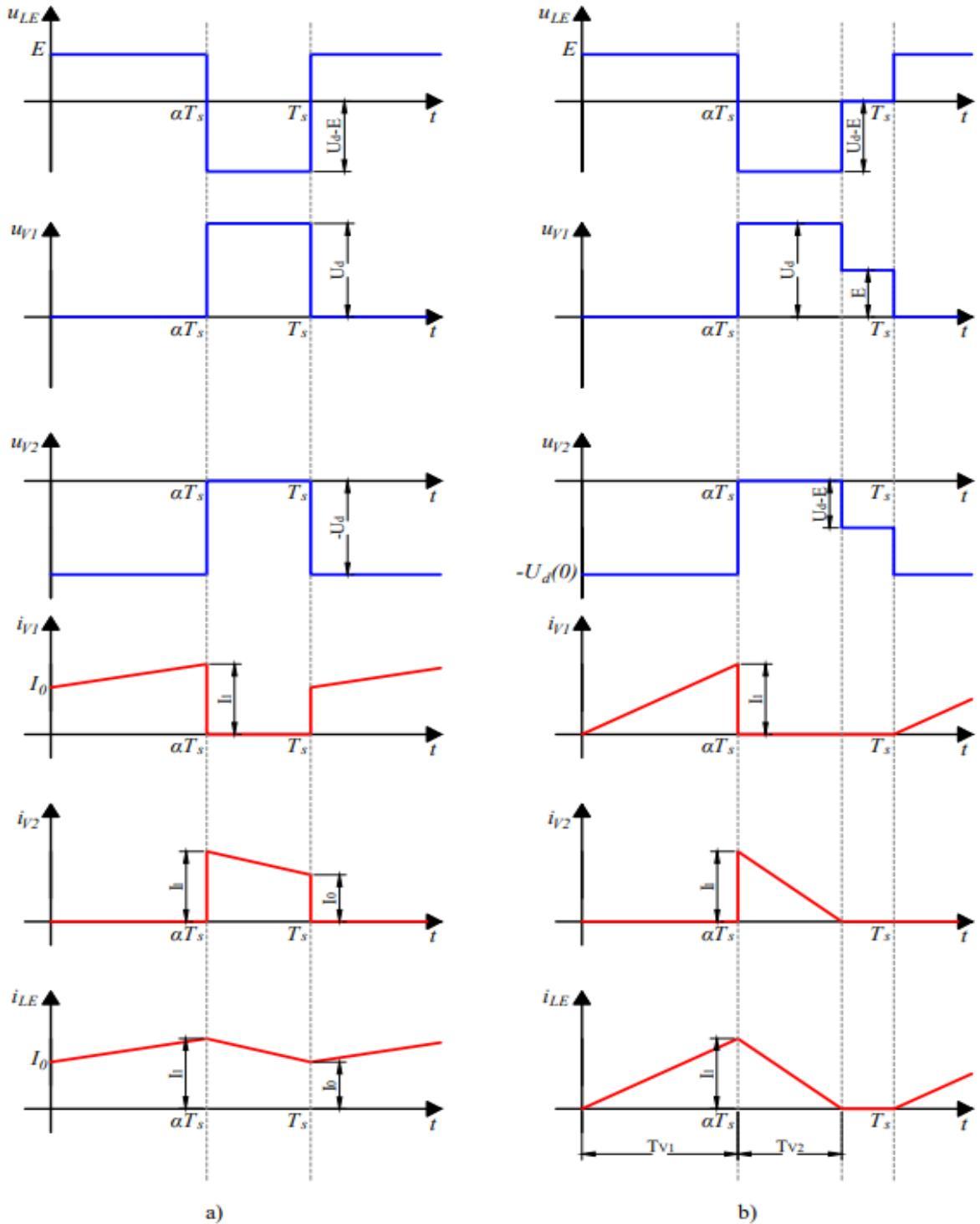
Slika 3.5. Karakteristični valni oblici uzlaznog pretvarača u:
