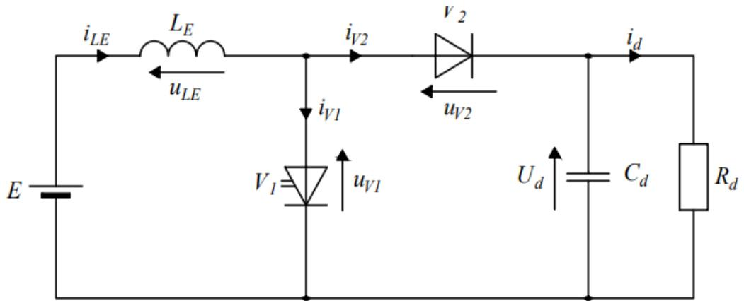
Slika 3.1. Nadomjesna shema istosmjernog uzlaznog pretvarača napona
