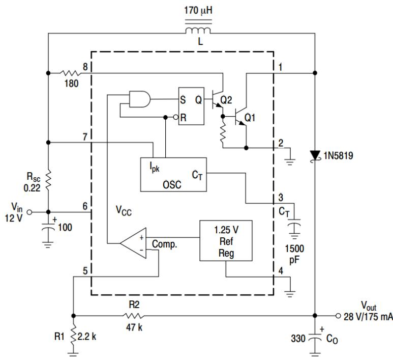
Slika 4.2. Shema uzlaznog pretvarača napona 12V/28V koristeći MC34063A [1]
