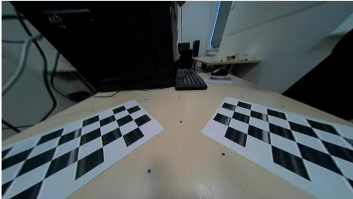
Slika 3.14. Prikaz slike s prednje kamere nakon ispravljanja izobličenja sa skaliranjem
