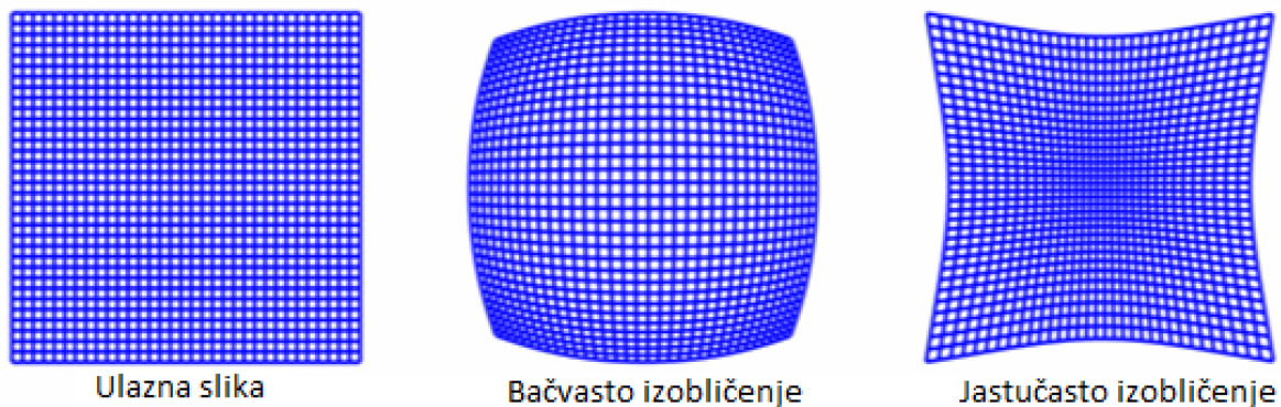
Slika 2.2. Učinak bačvastog i jastučastog izobličenja na kvadratnoj mreži [1]
