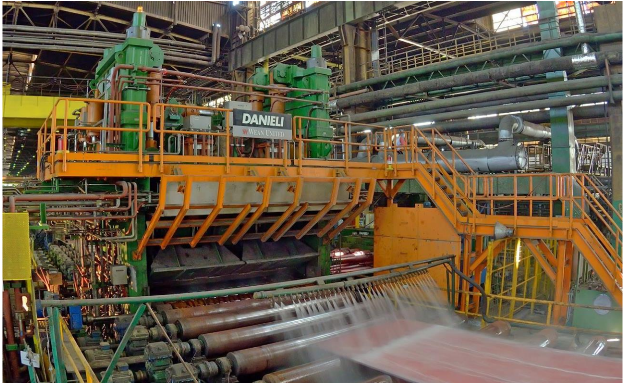
Slika 2.3 Prikaz stroja za površinsko ravnanje [2]
