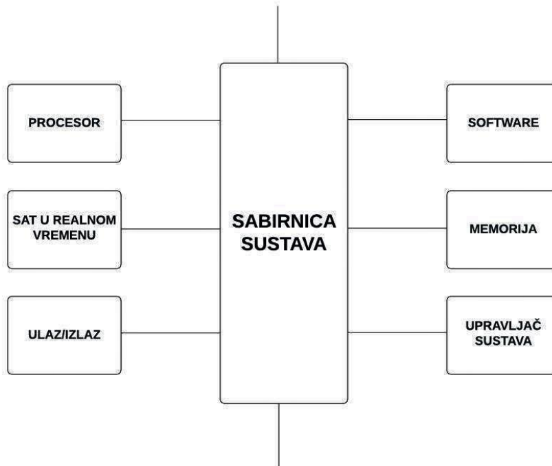
Slika 8. Blok dijagram računalnih funkcija pametnog brojila [1]
