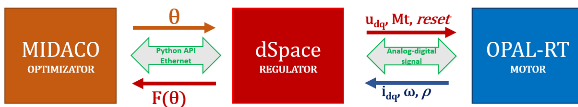
SL. 4.16: Grafički prikaz optimizacijsko-kosimulacijskog procesa
