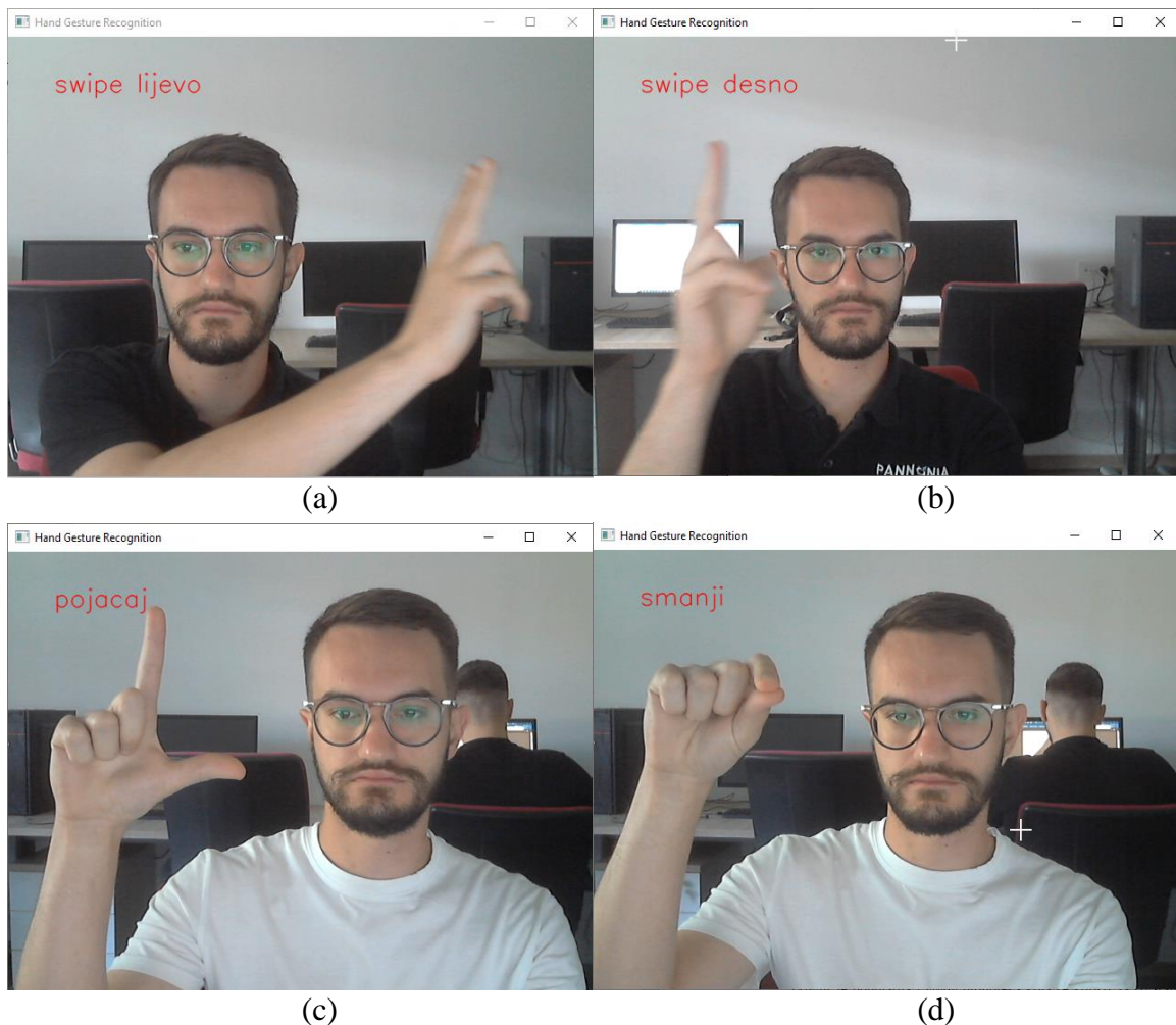
Slika 4.6. Primjer ispisivanja klase u test_app aplikaciji nakon učinjene i pravilno detektirane geste: (a) „swipe lijevo“, (b) „swipe desno“, c) „pojačaj“, d) „smanji“
