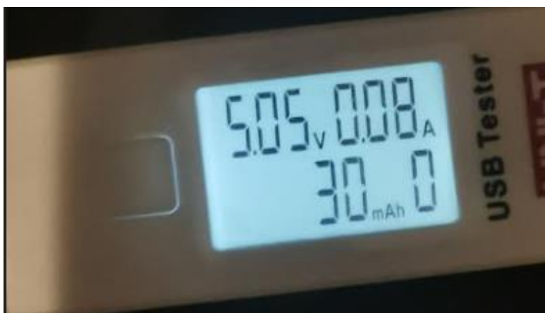
Sl. 5.3. Vrijednost struje nakon odaslane TCP poruke
