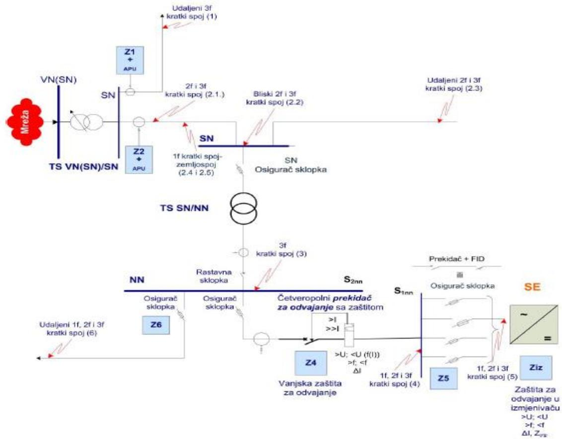
Slika 4.2. Generalni nacrt Kvarova SE > 100 kW [2]
