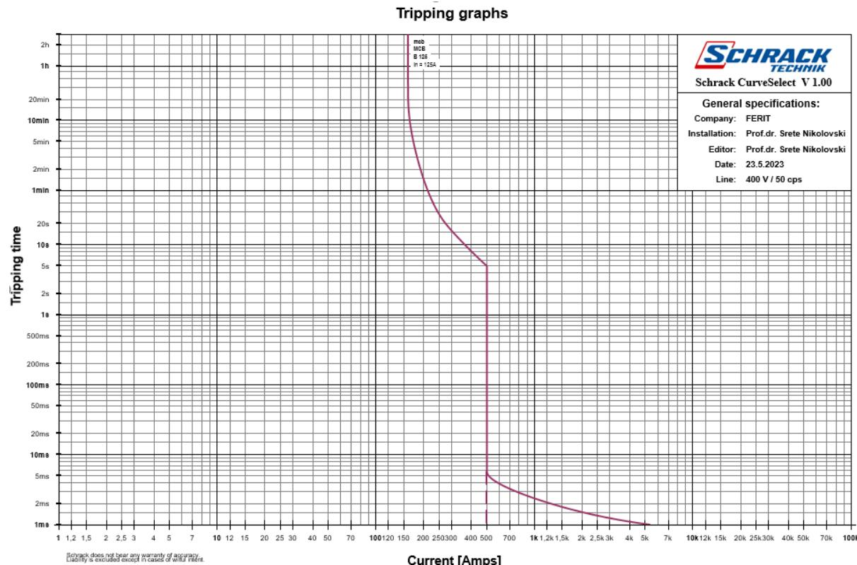
*Slika 4.8. karakteristike prekidača Schrack MCB 125 A*
