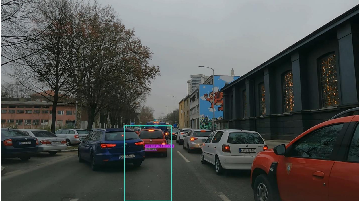
Slike 3.26. Filtriranje detekcija graničnog okvira registarske tablice vozila na one koje se nalaze unutar područja ispred vozača – 2. primjer
