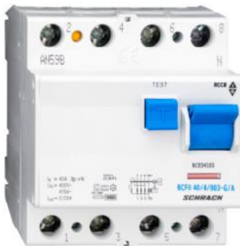
Slika 7.12. FID sklopka 40-4-03/A, S izvedba, za frekventne pretvarače (tip U), serija BC, Tip A (osjetljiva na pulsne struje), Norma EN 61008
