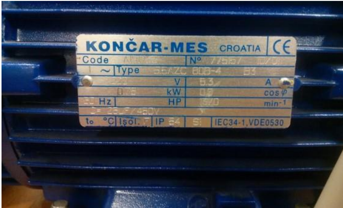
Slika 2.4. Nazivna pločica jednofaznog asinkronog motora marke Končar
