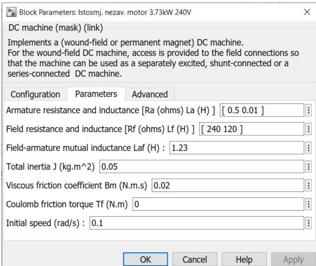
Sl. 6.2. Parametrisiranje motora 3,73 kW, 240 V
