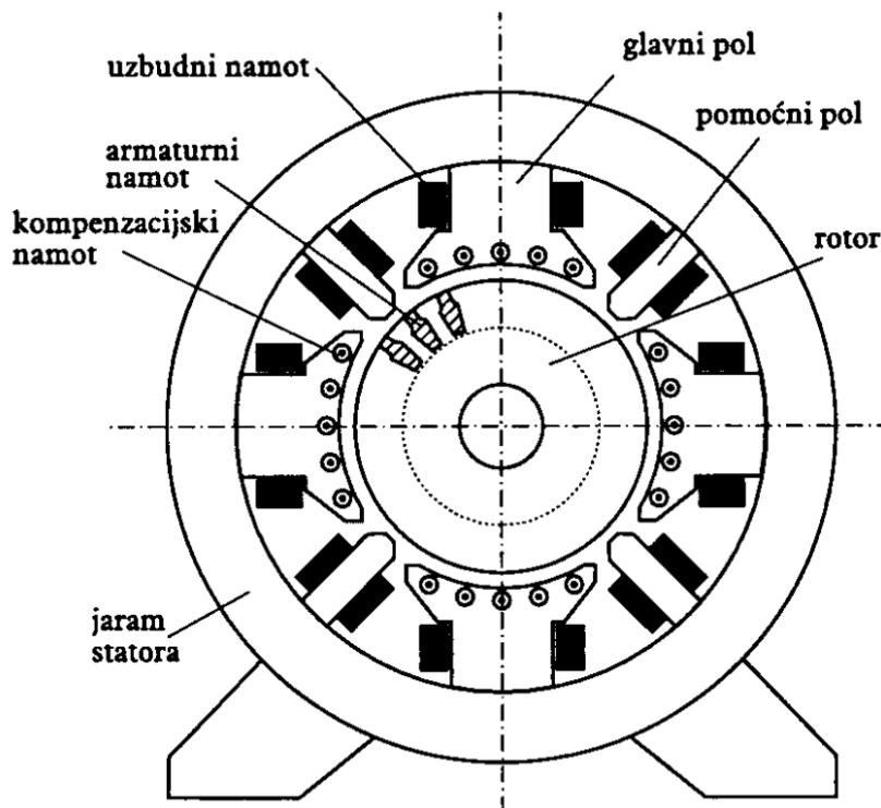
Sl. 2.1. Skica poprečnog presjeka istosmjernog stroja [2]
