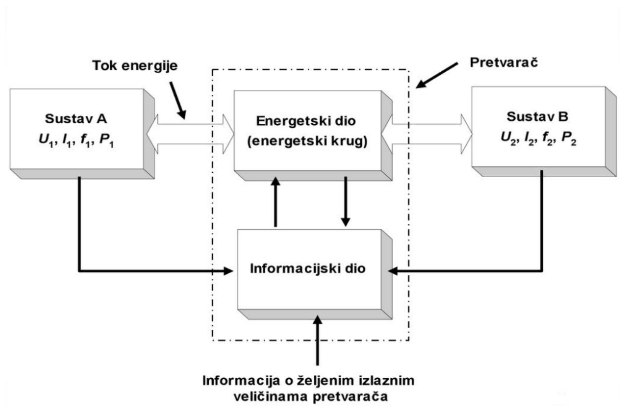
Sl. 4.1. Struktura električnog energetskog pretvarača [7]
