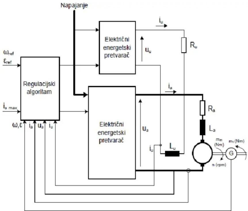
Sl. 3.2. Sustav regulacije armaturne struje i brzine istosmjernog stroja s nezavisnom uzbudom [7]
