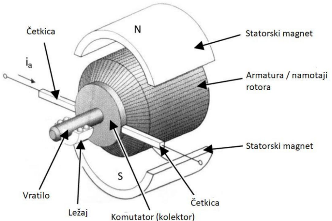
Sl. 2.2 Dijelovi istosmjernog motora[11]
