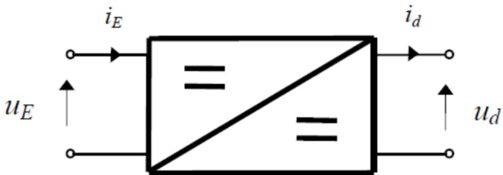
Sl. 5.1. Simbol istosmjernog pretvarača[13]
