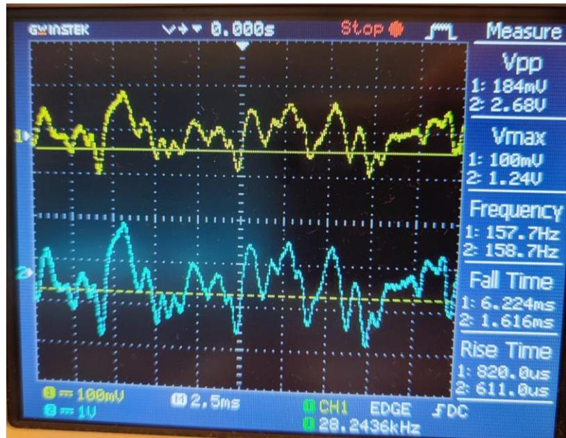
Slika 5.9: Signal gitare u True Bypass načinu rada
