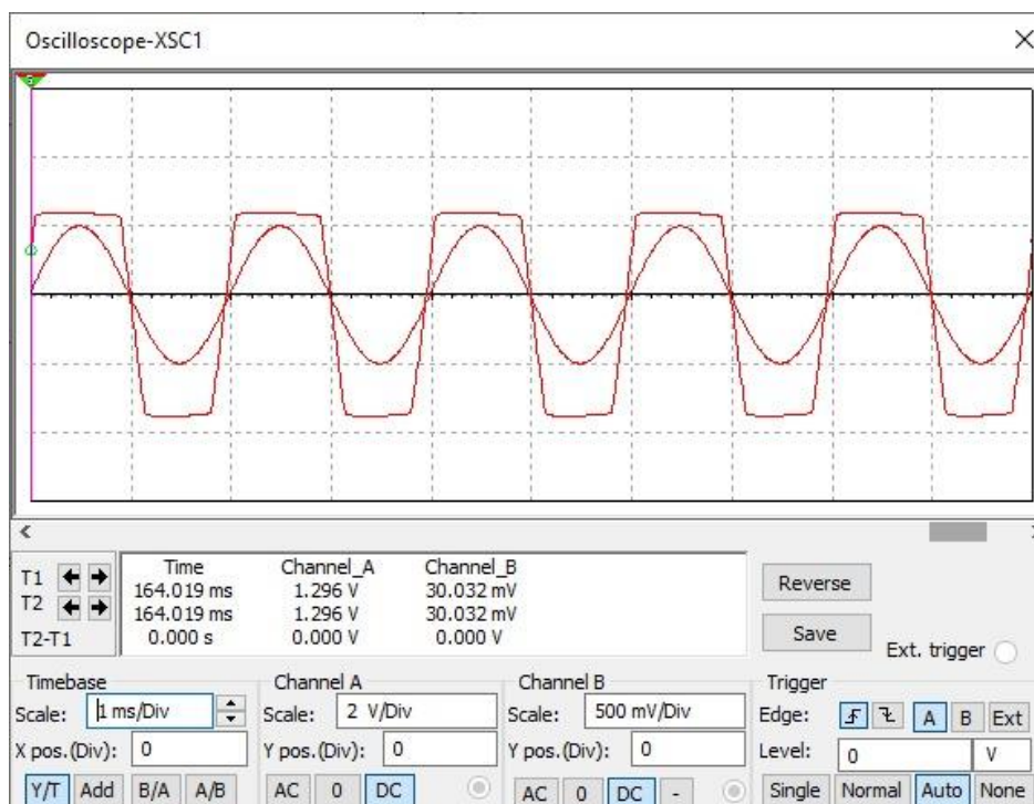
Slika 6.9: Prikaz ulaznog i izlaznog signala kada je potenciometar L i C postavljen na 0% pri amplitudi 600 mVpp i frekvenciji 500 Hz
