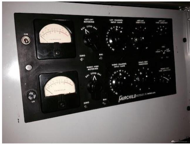
Slika 2.4: Cijevni kompresor
