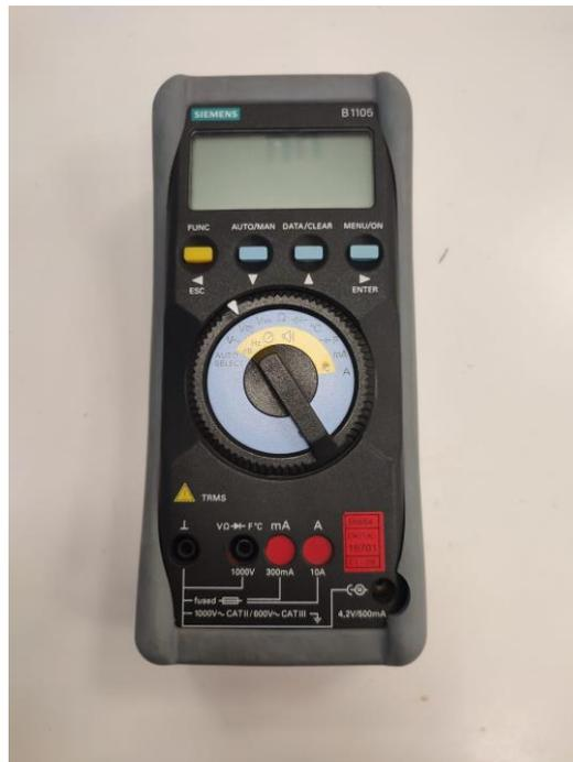
Slika 5.16. Siemens B1105 digitalni multimeter.
