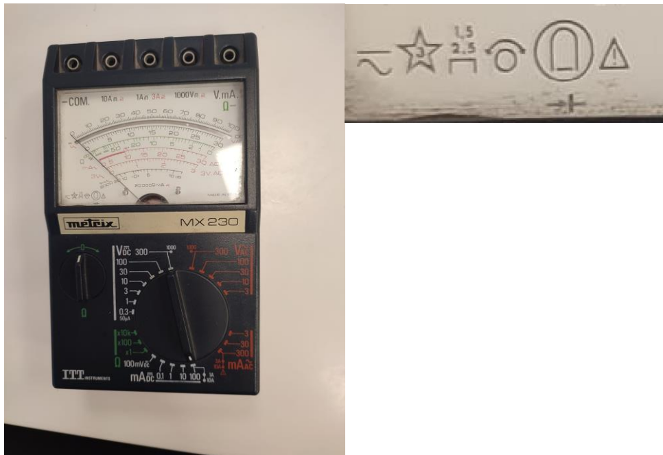
Slika 5.11. MX 230 – instrument s pomičnim svitkom sa ugrađenim ispravljačem i njegove značajke.
