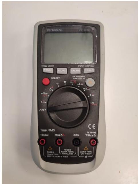
Slika 5.13. Voltcraft VC 870 digitalni multimetar
