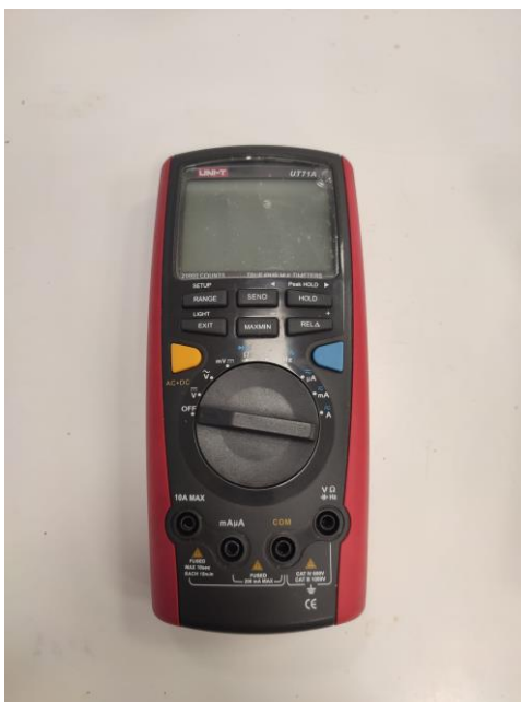
Slika 5.14. UNI-T UT71A digitalni multimeter
