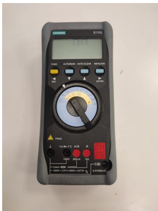
Slika 5.16. Siemens B1105 digitalni multimeter.
