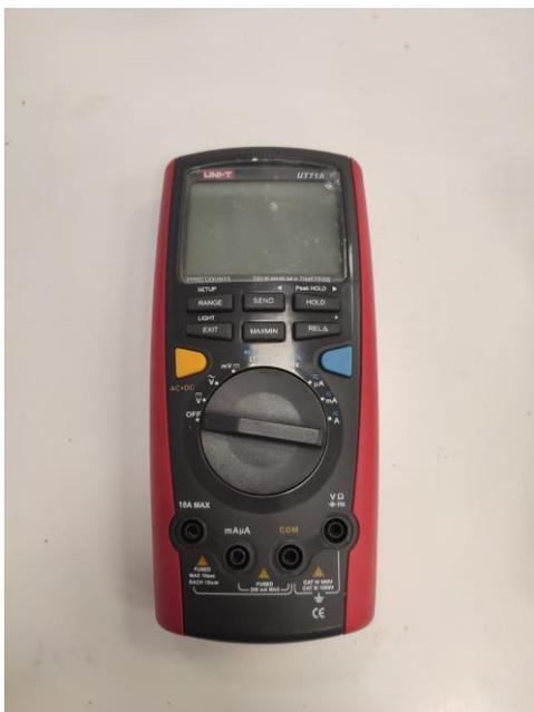
Slika 5.14. UNI-T UT71A digitalni multimeter
