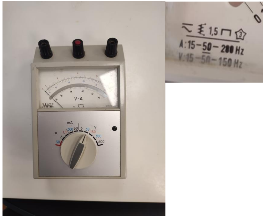
Slika 5.10. Siemens instrument s pomičnim željezom i njegove značajke.
