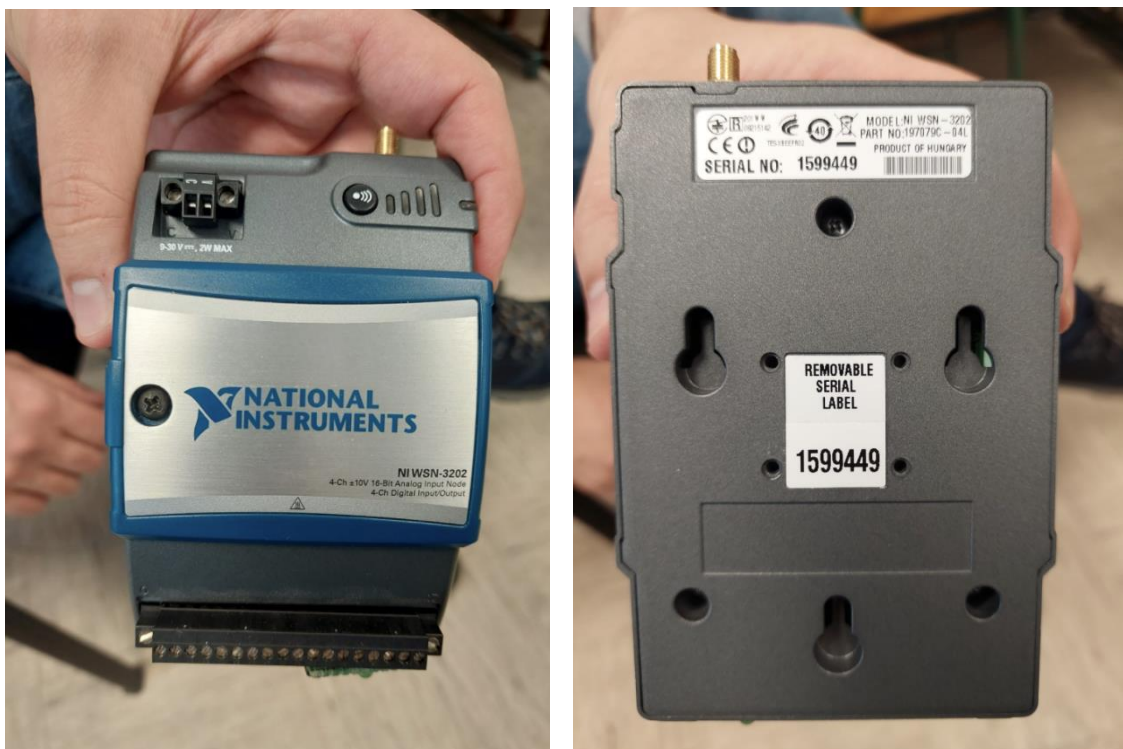
Slika 4.6 Prikaz korištenog NI WSN-3202 uređaja
