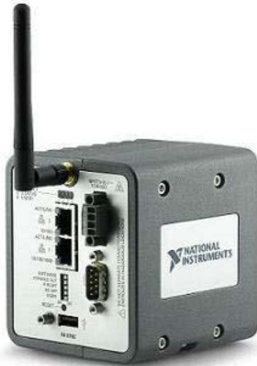
Slika 3.1 NI WSN-9792 kontroler
