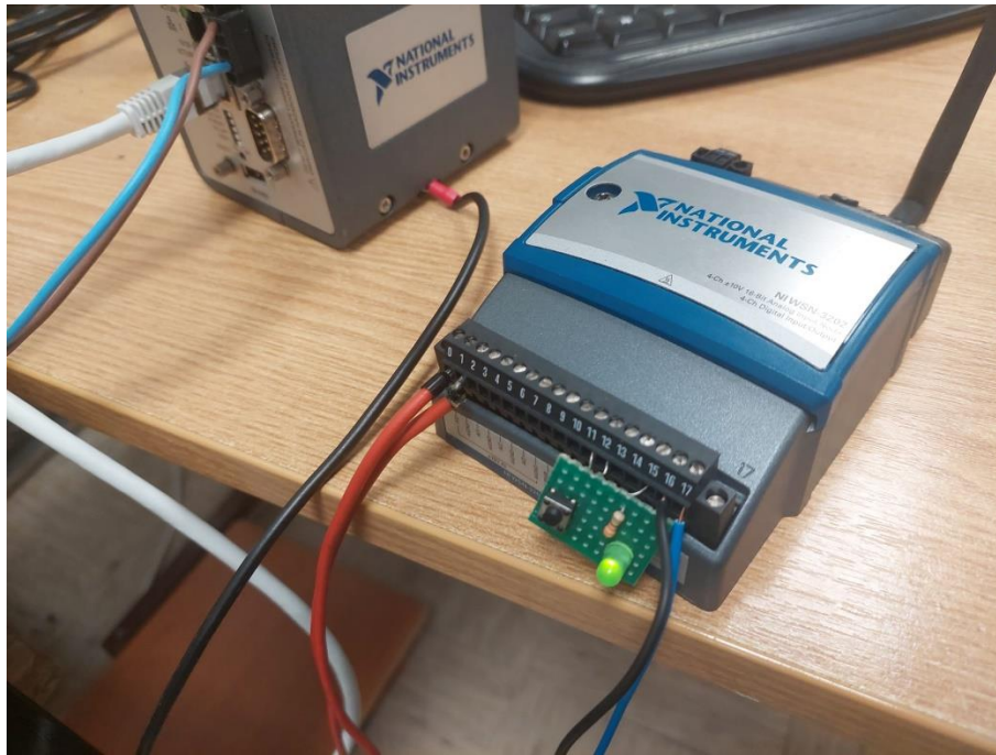
Slika 4.20 Prikaz upaljene LED diode na uređaju
