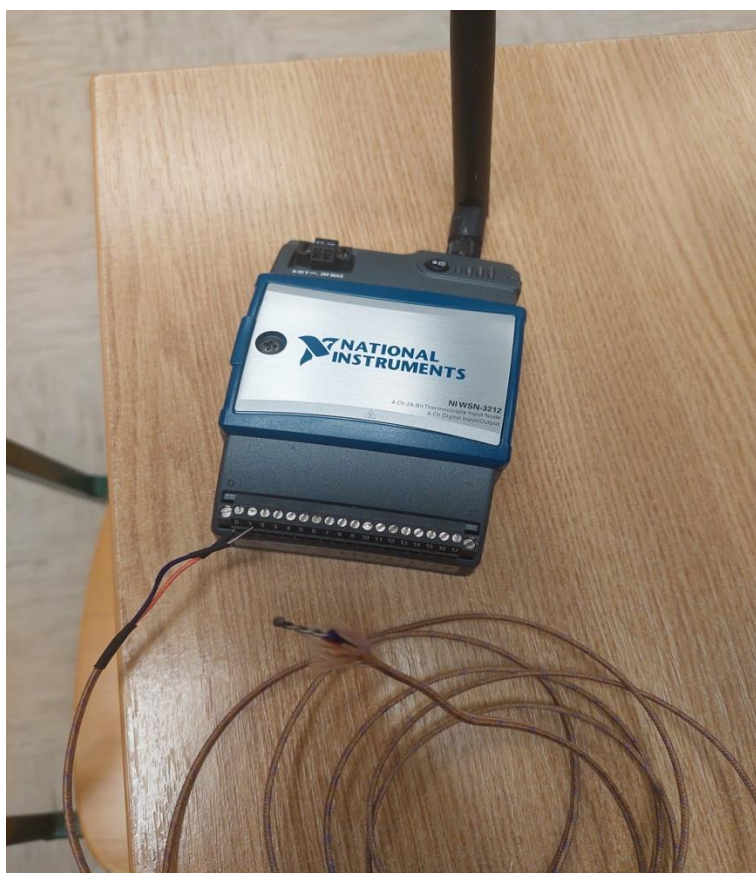
Slika 4.7 Prikaz korištenog NI WSN-3212 uređaja sa priključenim termoparom
