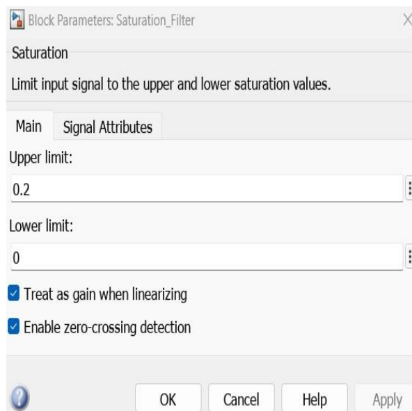
Slika 4.6. Parametri saturation bloka Kiselgur filtra.
