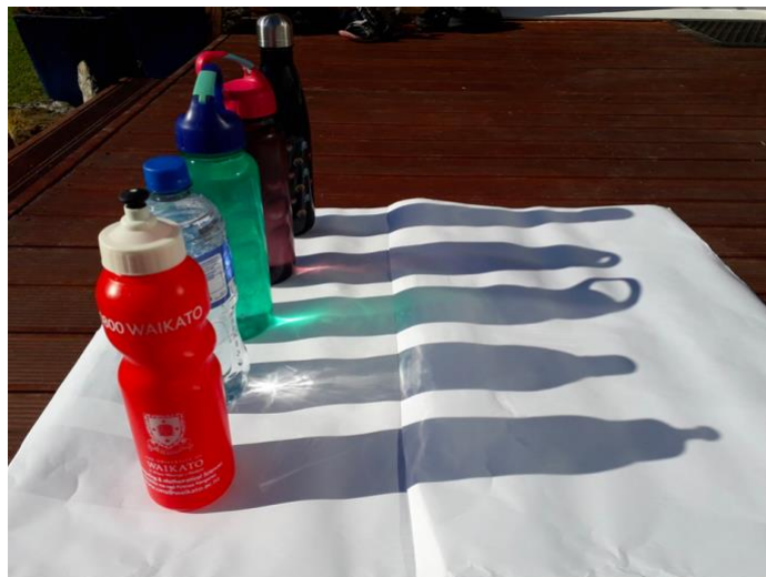
Slika 3.6 Izobličenje sjene i sjaj uzrokovan svjetlošću koja prolazi kroz transparentni materijal
