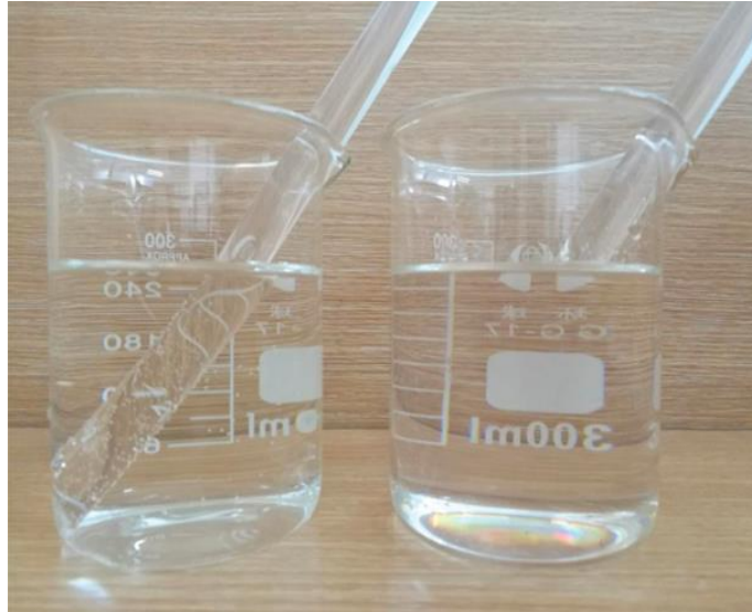
Slika 3.5 Nevidljivost transparentnog medija (desna čaša) u tekućini kojoj je indeks loma blizak indeksu loma medija
