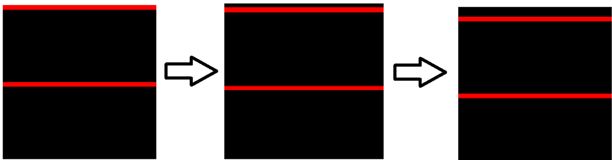
Slika 3.2. Prikaz načina skeniranja ledica na RGB LED matričnom pokazniku brzine skeniranja 1/32.
