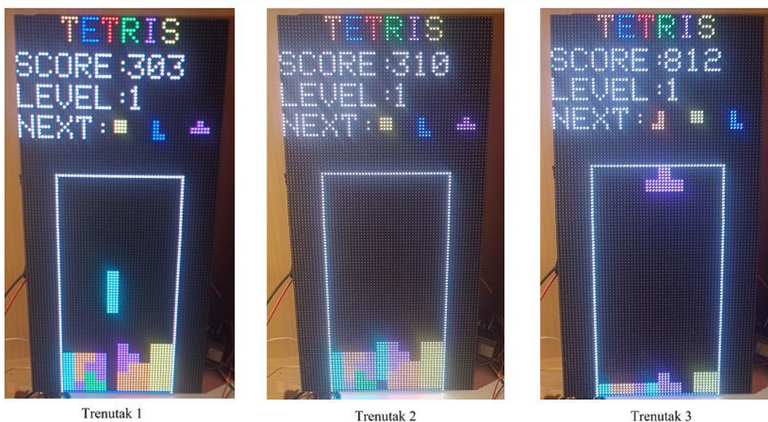
Slika 4.6 Testiranje provjere punih linija, brisanja, dodjele bodova i ispisivanja ispravnog stanja bodova na pokazniku
