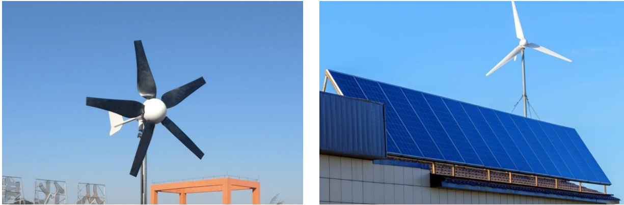
Slika 4.1. Primjer rotora malih vjetroagregata s petorima (lijevo) i trima lopaticama (desno) [14] [15]
