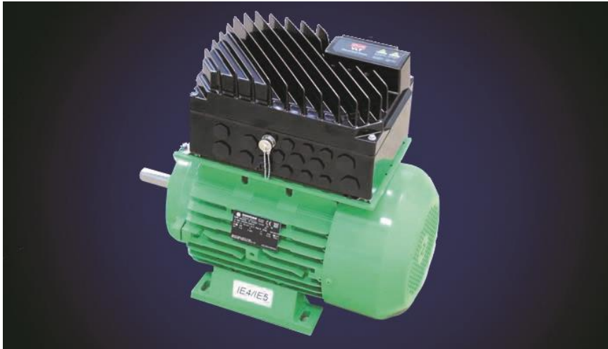
Slika 2.1. Sinkroni reluktantni motor [2].
