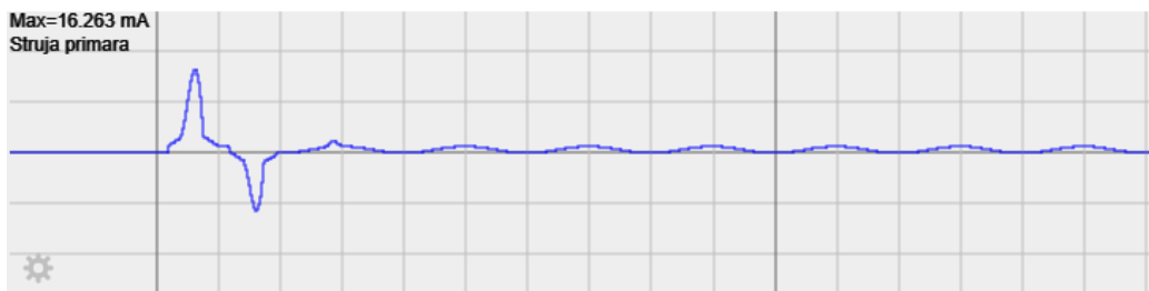
Sl. 5.5 Početno uključenje ispravljača pri neregularnom režimu rada
