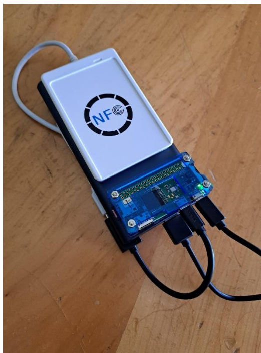
Sl. 3.1. Čitač spojen na Raspberry Pi Zero W
