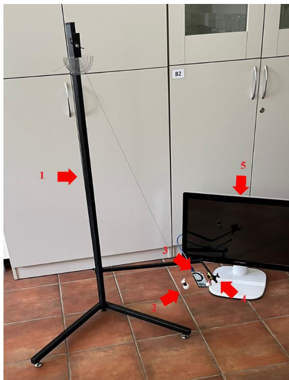
Slika 3.1. Maketa prigušenog oscilatora
