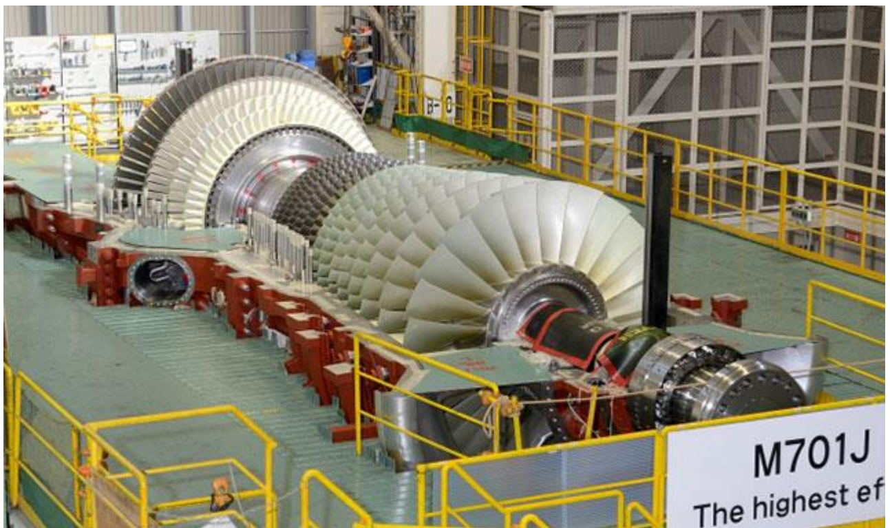
Slika 3.4. – Mitsubishi M701J turbina [12]
