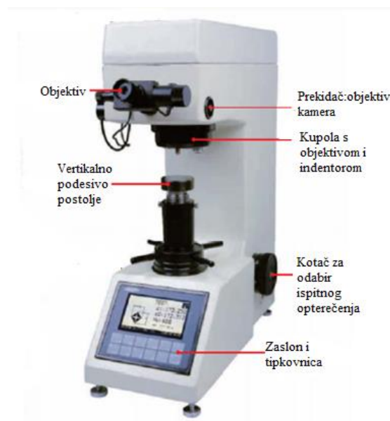
Sl.3.6. Vickersov uređaj za ispitivanje tvrdoće [7]
