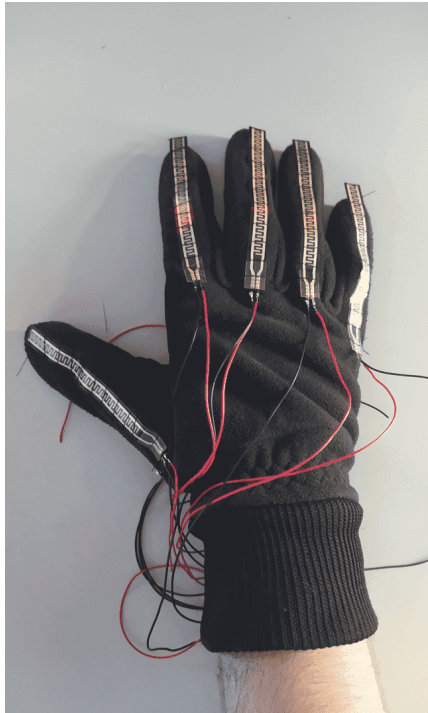
Sl. 3.1 Upravljačka rukavica sa senzorima
