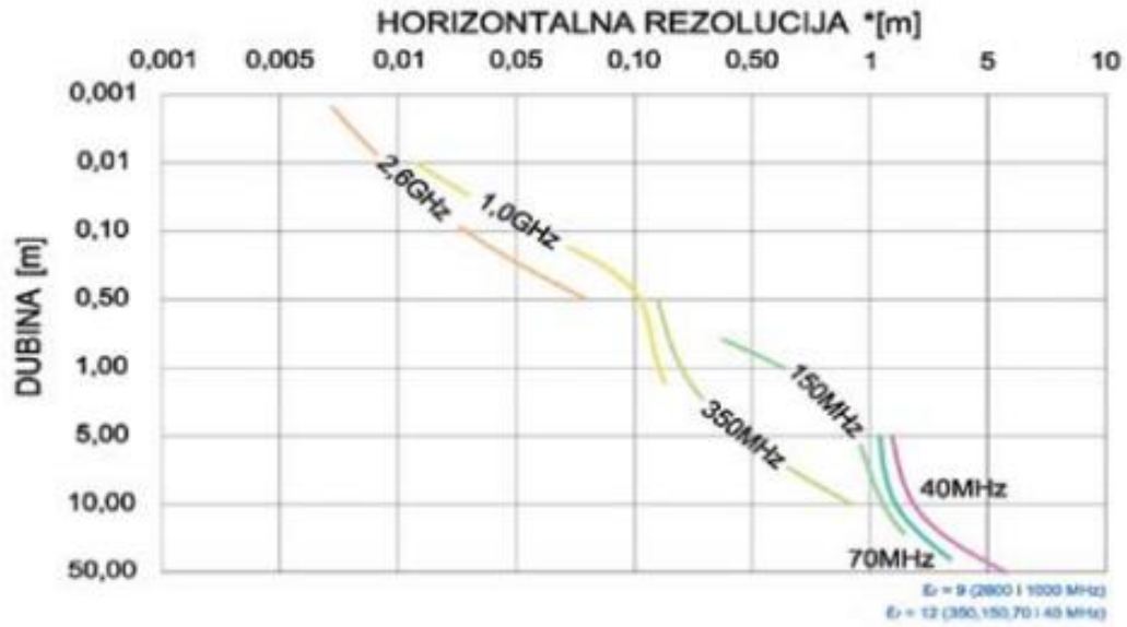
Slika 4.7. Horizontalna rezolucija GPR-uređaja prema dubini i centralnoj frekvenciji [8]
