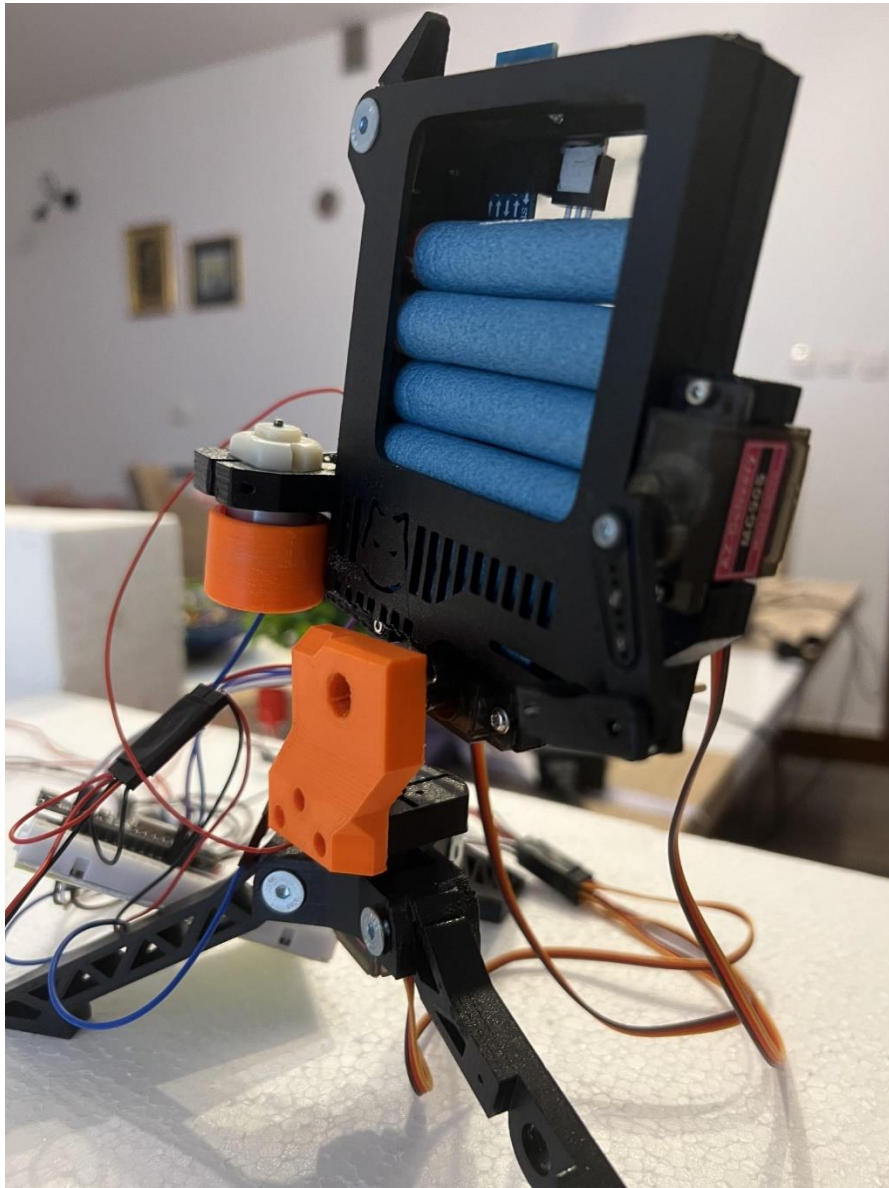
Slika 3.10. Prikaz nogice povezane sa servo motorom.
