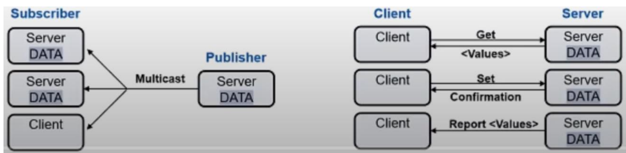
Slika 2.6. Vrste komunikacija: GOOSE (lijevo) i C/S (desno) [11]
