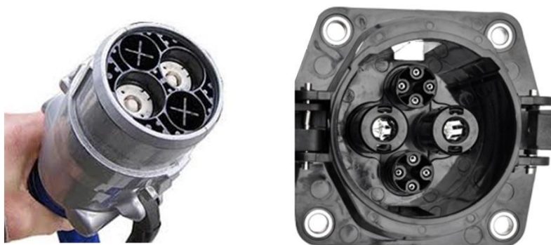
Slika 3.1.2.3. CHAdeMO konektor: utikač lijevo i utičnica desno. [10]
