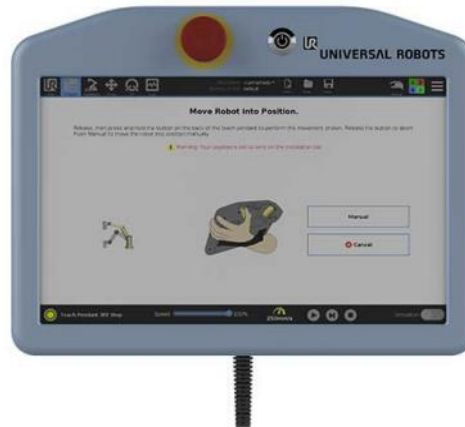
Slika 4.11. Interaktivni ekran za upravljanje robotom
