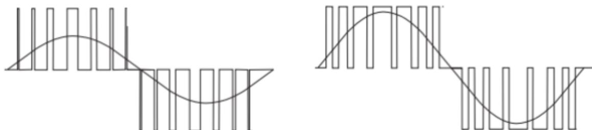
Slika 4.23. Utjecaj promjene širine impulsa na amplitudu osnovnog harmonika [13]
