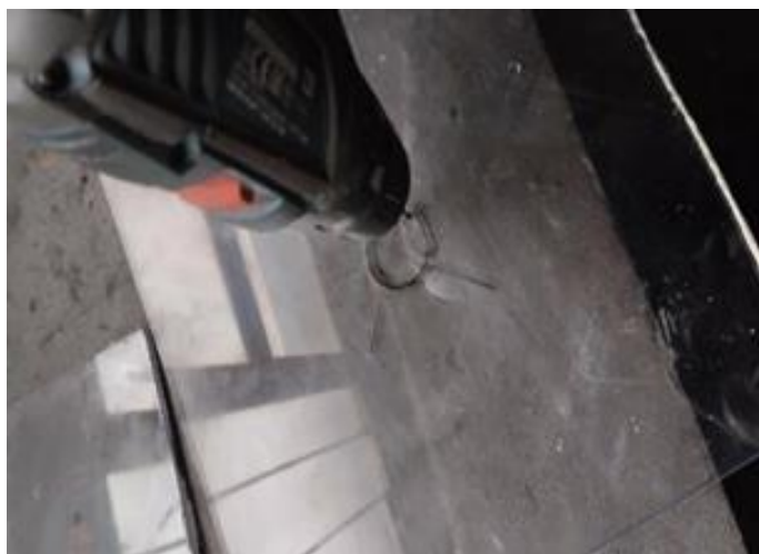
Slika 5.3 Bušenje rupa na postolju
