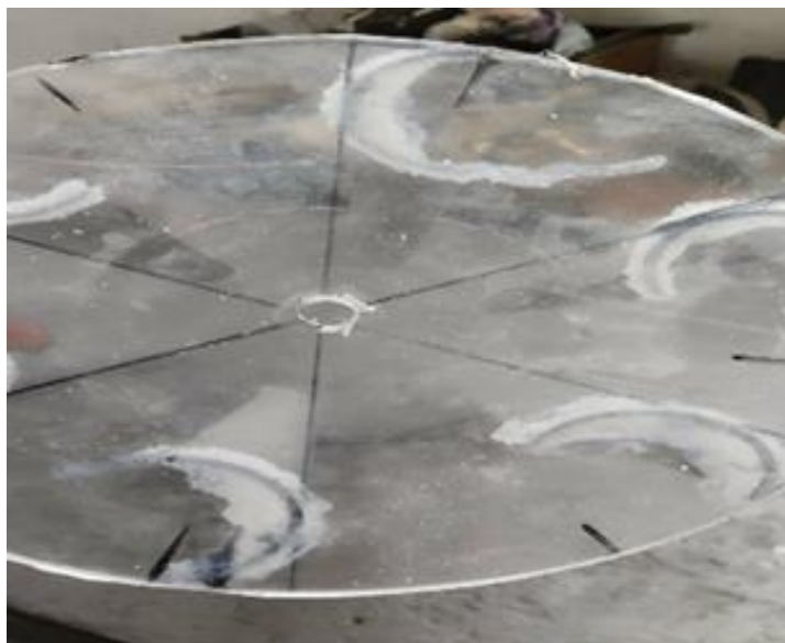
Slika 5.2 Kružni diskovi vjetroturbine s označenim mjestima za položaj lopatica
